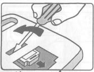
Pour enlever le module, enlever les piles. Introduire un tournevis, une clé ou une pièce de monnaie dans la fente qui se trouve au dessus du compartiment des piles et l'incliner pour repousser le module. Placer ensuite le tournevis dans l'encoche du module et le tirer doucement
